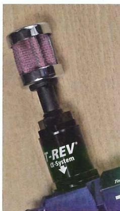
吸入部分は負圧によるツブれを防止するために、ステンレスで剛性が高められた。もちろん、エアクリーナーと同様のフィルターがセットされているので、エンジン内部に異物を吸い込むようなこともない。
