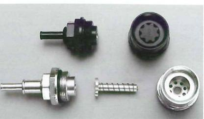
T-REV αシステムの流量コントロール部分は写真のような部品で構成されている。バルブシャフトにセットされたスプリングの反発力は、調整式となるトップ部分でNV350のQR20DEに最適化されているので、特に気にすることなく装着するだけだ。
