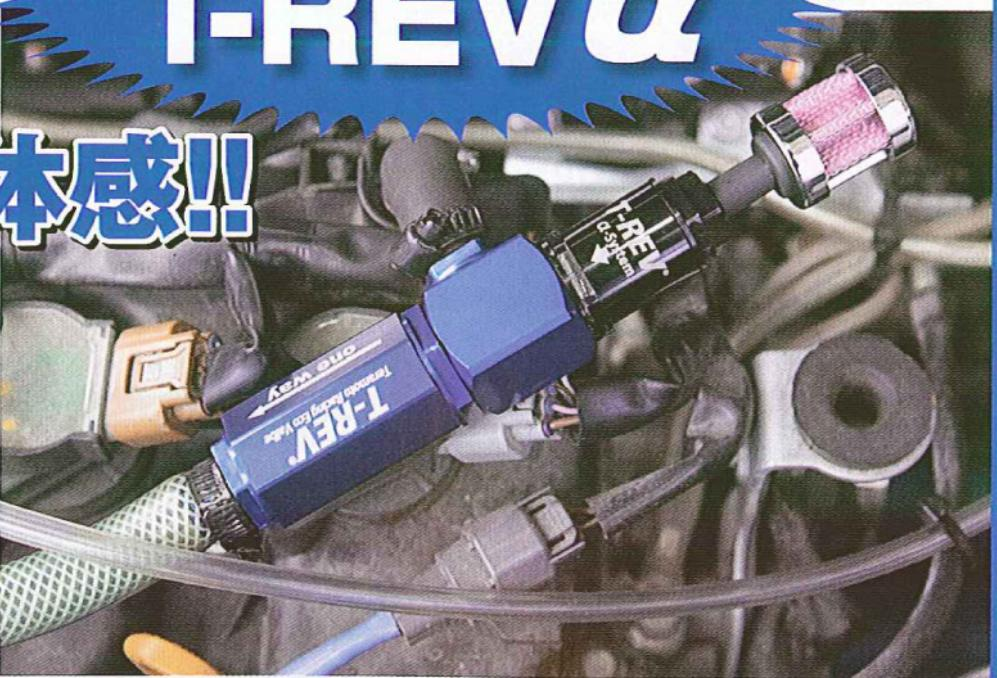
現在、コペン用取付けキットを含めて、T-REVを取り扱っているティクオフが、次のステップとして「T-REV α（アルファ）」を開発しているとのスクープが舞い込んできた。T-REVとは、寺本自動車商会が独自開発し、特許を取得しているクランクケース減圧バルブの商品名だ。クランクケースを負圧にすることでポンピングロスを低減し、アクセルレスポンスを向上させる効果などがある。T-REV αは、その進化版。T-REVの効果をより高めるために、車種ごとに適正な減圧値が設定できるようにシステムをグレードアップ。今回、ティクオフと寺本自動車商会との共同開発でエッセのテストを開始。鈴鹿ツインサーキットやモーターランド鈴鹿でサーキットでの試走を何度もトライ中。ラップタイムでも確実に従来品を上まわっているとの情報。実際に、T-REV αを装着したティクオフエッセをドライブしたオカPもその効果を絶賛。今後が楽しみだ!
