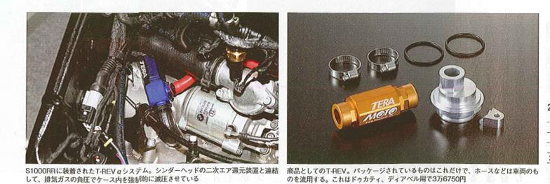
S1000RRに装着されたT-REVαシステム。シッターヘッドの二次エア還元装置と漏れ防止、排気ガスの内圧を積極的に減圧させている
