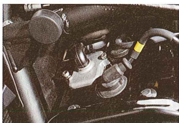
↑αシステムのキモとなるのが、シリンダーヘッドに位置する二次エア供給装置である。排気で生じる負圧を利用してクランクケース内のブローバイガスを「引き抜き」、積極的な減圧をうながすのだ
