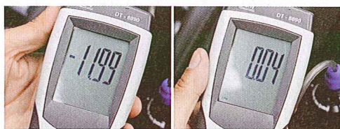
←専用のメーターでクランクケース内圧を確認してみると、ノーマルではほぼ大気圧を示したが(写真真右)、αシステムを装着して測定すると、約マイナス12kpaの減圧を表示した
