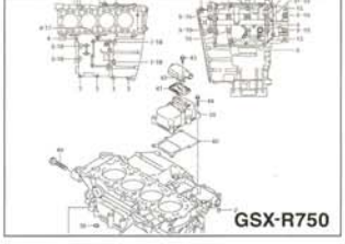
●写真はGSX1300RハヤブサとGSX-R750（ともに11年式）のパーツリストの一部。クランクケースにT-REVバルブがあるのを確認できる（ハヤブサが49番、GSX-R750が41番）。ススキに限らずKTMMでも同種のバルブが純正採用されており、今後も採用車両が増えると思われるパーツだ
