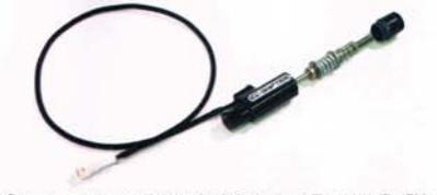
◎イージーシフターでは信頼性の高い磁気センサーを用いており、高い耐久性を実現。また、センサーに付随するスプリングも硬さを吟味し、適和感のないシフトフィールを実現する。なお、センサー部はオーバーホール可能だ
