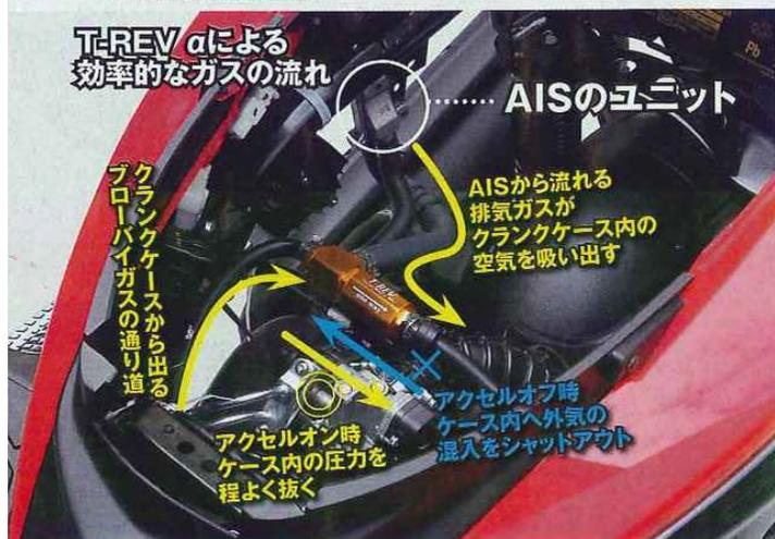
T-REV αの取り付け方法は①シートを取り外す。②ブローパイプホースの間にT-REV αを取り付ける。③T-REV αとAISのユニットを付属のホースで接続する。これでOK。作業時間は20分程度。
