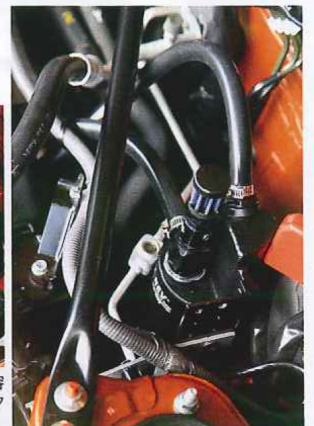
86&BRZ用など主要車種はステークキットが用意され、容易な装着ができるようになっている。右上、バッテリーとタワーパーの間あたりに装着されているのがわかるかな？
