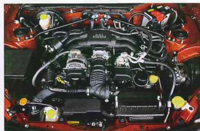
86&BRZ用など主要車種はステークキットが用意され、容易な装着ができるようになっている。右上、バッテリーとタワーパーの間あたりに装着されているのがわかるかな？
