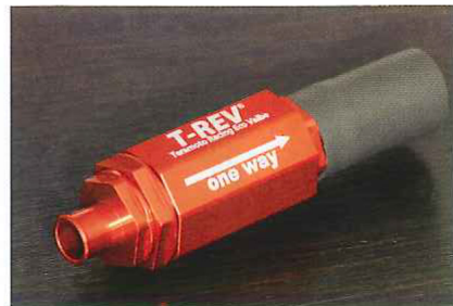
④ T-REV本体のなかにはワンウェイバルブが組み込まれており、これが外気の侵入を遮断しつつ、クランクケース内を減圧。エンジンブレーキの緩和やエンジン内部パーツの回転運動がよりスムーズになるのだ
