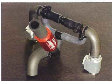
② 従来のT-REVはリードバルブのみでケース内を減圧する自然減圧方式となる。一方、αシステムは排気の負圧を利用し、より効率的に減圧を行なう強制減圧方式。これはMotoGPでも見られる方法だ
