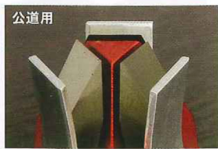
③ T-REV本体も見えない部分で進化を続けている。内部に組み込まれているワンウェイバルブは公道用はゴムを組み込み、内部のシムが固着しないようにしている。一方、レース用では定期的なメンテナンスを行なうため、効率を求めてシムのすき間を空けずしているのだ。
