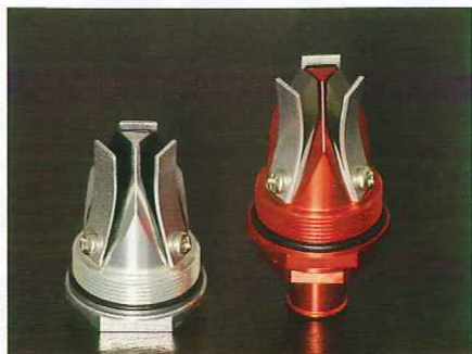
③ T-REV本体も見えない部分で進化を続けている。内部に組み込まれているワンウェイバルブは公道用はゴムを組み込み、内部のシムが固着しないようにしている。一方、レース用では定期的なメンテナンスを行なうため、効率を求めてシムのすき間を空けずしているのだ。
