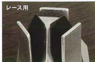
③ T-REV本体も見えない部分で進化を続けている。内部に組み込まれているワンウェイバルブは公道用はゴムを組み込み、内部のシムが固着しないようにしている。一方、レース用では定期的なメンテナンスを行なうため、効率を求めてシムのすき間を空けずしているのだ。
