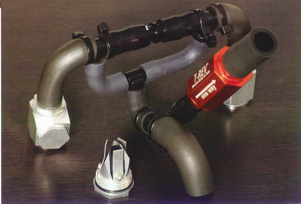
④ T-REV本体のなかにはワンウェイバルブが組み込まれており、これが外気の侵入を遮断しつつ、クランクケース内を減圧。エンジンブレーキの緩和やエンジン内部パーツの回転運動がよりスムーズになるのだ
