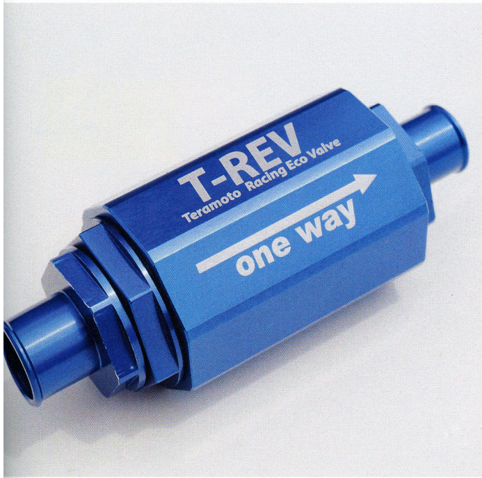
↑円すい形のワンウェイバルブは3枚のリードバルブで構成されており、クランクケースの圧力を効果的に分散する。あらゆる車種への装着を考慮したL字アダプターや、プロバイガスに含まれる水分やオイルの進入を防ぐオイルセパレーター、オイルフィルターキャップに取り付けるタイプも用意
