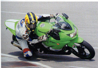
↑T-REV装着のニンジャ250Rでテスト走行する寺本氏。このテストは小規模なサーキットで行なわれているのだが、短いストレートでは非装着車よりも1速上のギヤまで入り、トップスピードを伸ばすことができた
