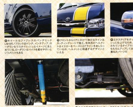
●コンフォータブルキットに加え、ダンパーもビルシュタインの強化タイプに変更。このダンパーは寺本自動車商会で取り扱っていて、標準とローダウンの2つのタイプをラインナップしています。
