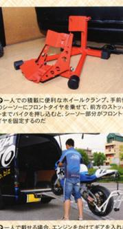
④ 大きな車の場合、エンジンをかけてドアを開けるのが大変な場合はラクに行なえる。だが、爪のないラダーを使う場合、ラダーが車から外れてしまうこともあるので、ラダーを固定する必要がある
