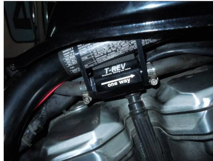
ガソリタンクを外すとシリンダーヘッドカバーからエアークリーナーBOXに繋がるホースが見えます。このブローバイホースをカットしマシン右側に出しフレームにタイラップで固定。Rバンクの前に組むとガソリタンクに隠れる事なく装着可能。
