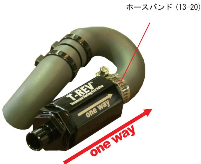
②の工程で作ったホースのUホース側をT-REV OUT側に繋げる。ホースバンド(13-20)で固定する。
