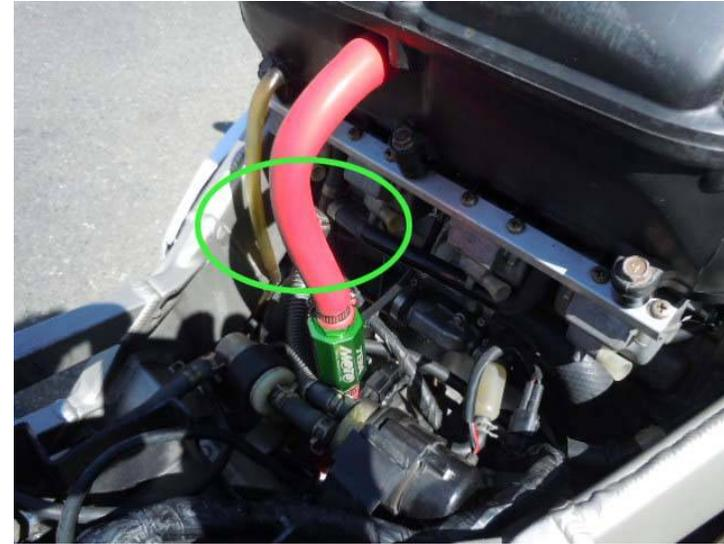
クランクケースからエアクリーナBOXに入っているブローバイホースの途中をカットして取り付けます。
