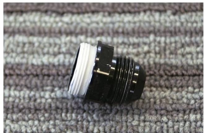
キットホースINにT-REV組み。ANアダプターNO8のOリングを外しシールテープを巻く。
