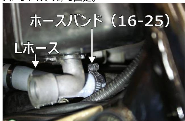
キットホースINを車体左側に出しLホースを組みタイラップで固定。Lホースの反対側をプローバイ
