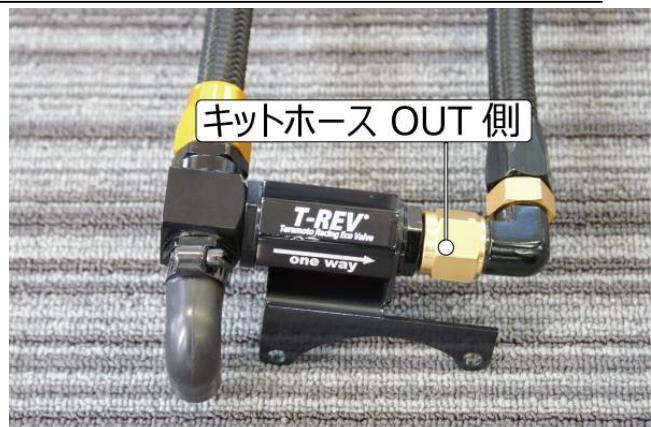
T-REV OUT側に専用ステー・ANアダプターNO8の順で組み。キットホースOUTを組む。
