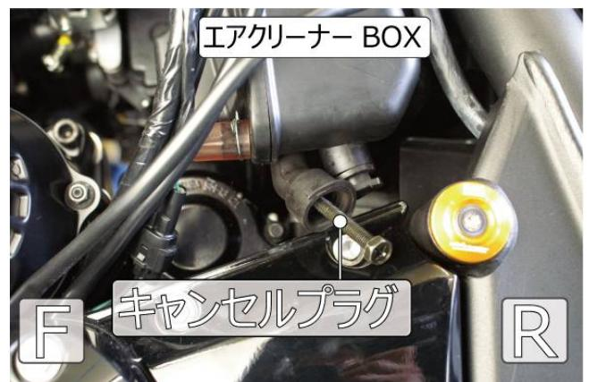
エアクリーナーBOXの下にあるL型純正プローバイホースのエンジン側を外し、このホースの中にキャンセルプラグを入れボルトのみ外します。タイラップで抜け防止でホースを絞めてください。
