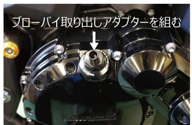
フィラーキャップを外しブローバイ取り出しアダプターを組む。
