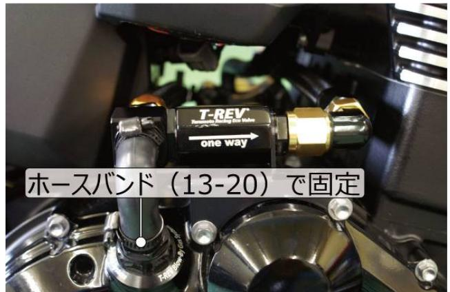
クラッチカバーのボルト2本を外しキットホースINをブローバイ取り出しアダプターに繋げホースバンド(13-20)で固定。専用ステーを組む。
