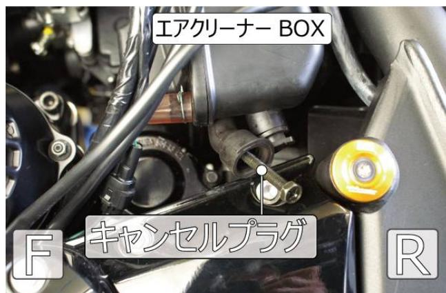
エアクリナー-BOXの下にあるL型純正ブローバイホースのエンジン側を外し、このホースの中にキャンセルプラグを入れボルトのみ外します。タイラップで抜け防止でホースを絞めてください。
