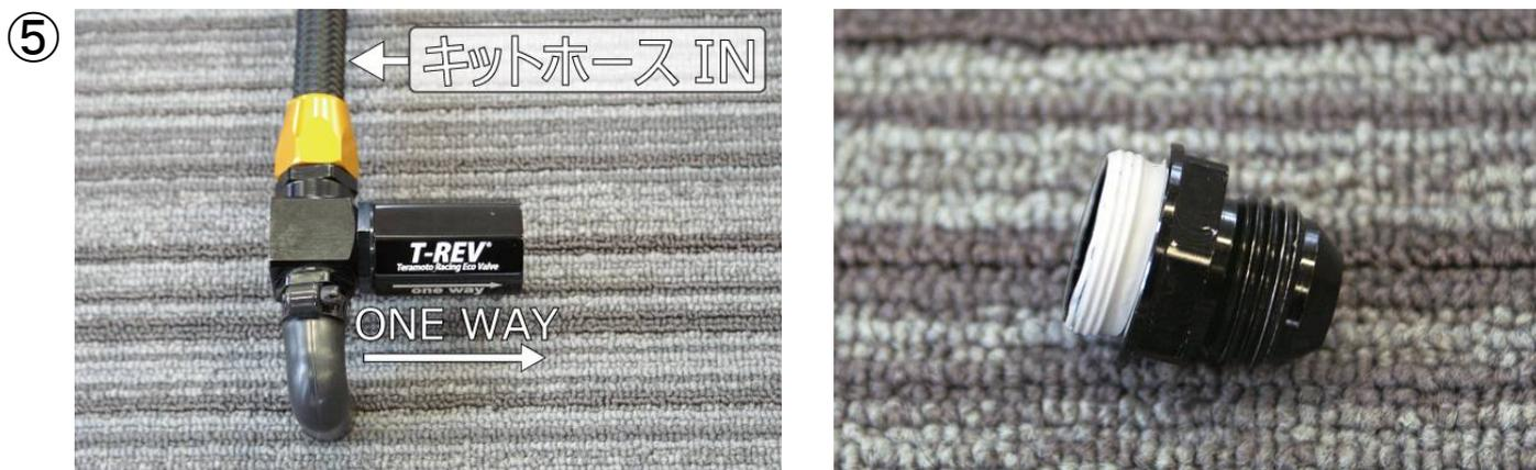
キットホースINにT-REV組み。ANアダプターNO8のOリングを外しシールテープを巻く。
