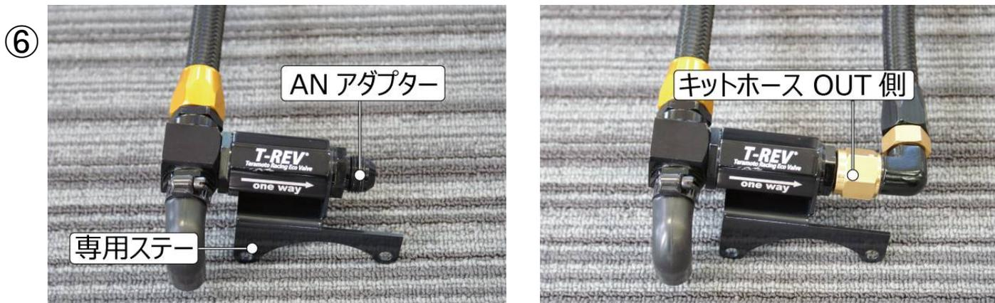
T-REV OUT側に専用ステー・ANアダプターNO8の順で組み。キットホースOUTを組む。
