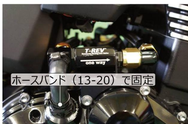
クラッチカバーのボルト2本を外しキットホースINをブローバイ取り出しアダプターに繋げホースバンド(13-20)で固定。専用ステーを組む。
