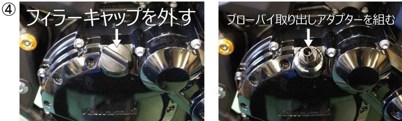
フィルターキャップを外しブローバイ取り出しアダプターを組む。
