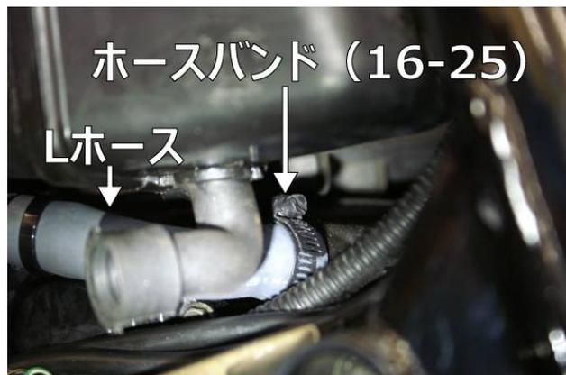
キットホースINを車体左側に出しLホースを組みタイラップで固定。Lホースの反対側をブローバイガス出口に組みホースバンド(16-25)で固定。
