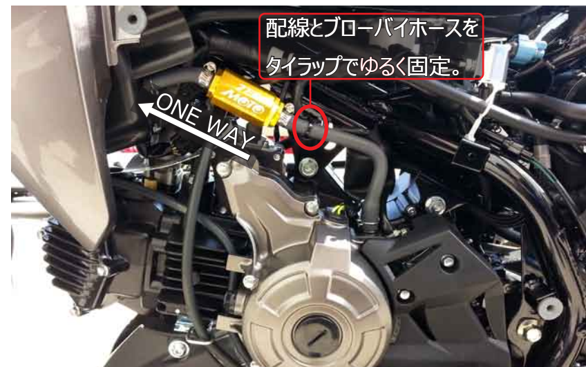
ブローバイホースをカットし T-REV を組む。
