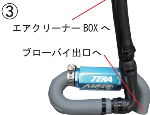
ガソリタンクを外しブローバイホースと入れ替える。Lホースはブローバイ出口へ、キットホースはエアクリナーBOXに繋ぎ、ホースバンドで固定する。エアクリナーBOX側はホースバンドの向きに注意。分解した純正パーツを組んで完成です。
