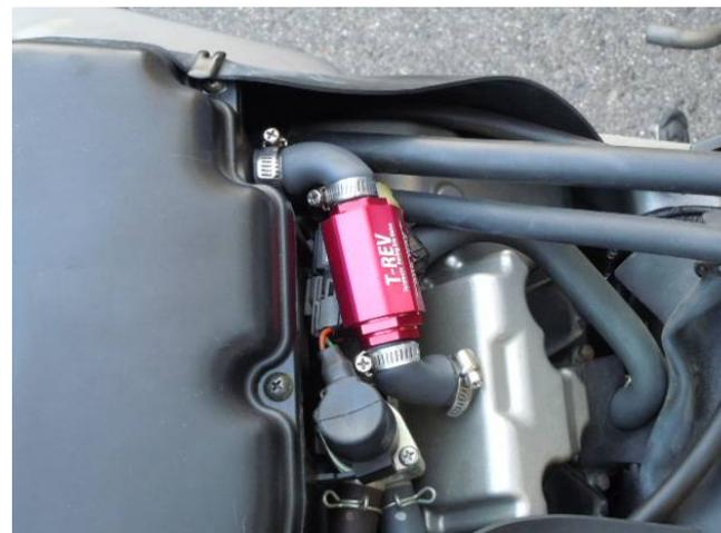
タンクを上げると見える後方バンクのヘッドからエアクリーナーに繋がっているブローバイホースをカットして取り付けます。
