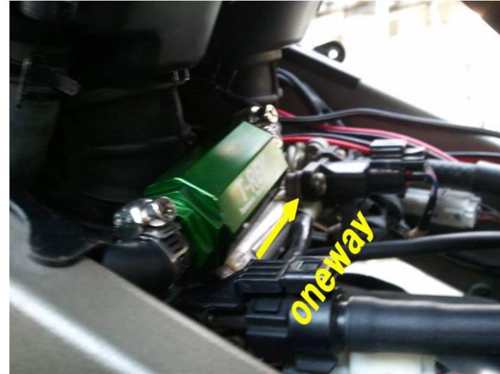
ガソリントankを外すとブローバイホースが見えます。エンジンからエアクリーターBOXに矢印が向かうように装着してください。
