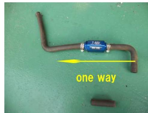
ガソリンタンクを外すと左側にブローバイホースがあります。これを外します。T-REVに合わせてホースをカットしT-REVを装着。下の写真のように見るところに組んであげるとカスタムにも最適です。
