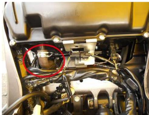
シート・サイドカウル・ガソリタンクを外すとブローバイホースが見えます。赤○のホースを外してください。リヤサスペンションの左にあるレギュレータのステーを、外した方が作業しやすいです。
