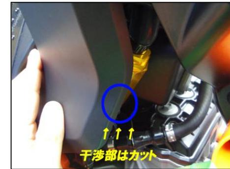
シート・ガソリンタンク・サイドカバーLを外すとブローバイホースが見えます。エアクリーナーBOXに接続されている方のホースをカットしT-REVを装着してください。
