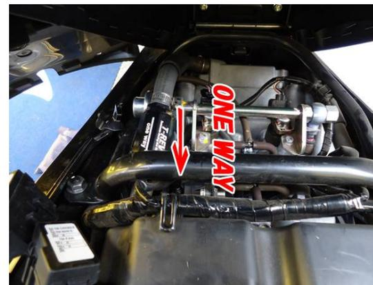
ブローバイホースをカットし写真のように取り付けます。
