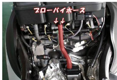
シートを外しタンクを上げるとブローバイホースが見えます。これを外します。
