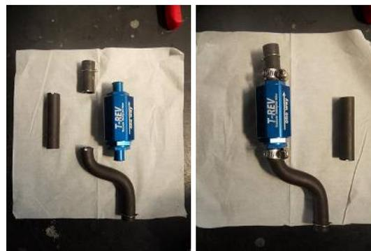
ブローバイホースをカットしT-REVを割り込ませます。これをエンジンに組み外したパーツを組んで完成です。
