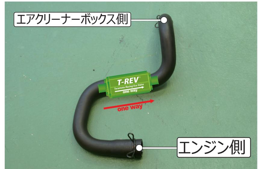
ガソリントankの前方をリフトアップ。純正減圧バルブを取り外し、ブローバイホースをカットし T-REV を組む。
