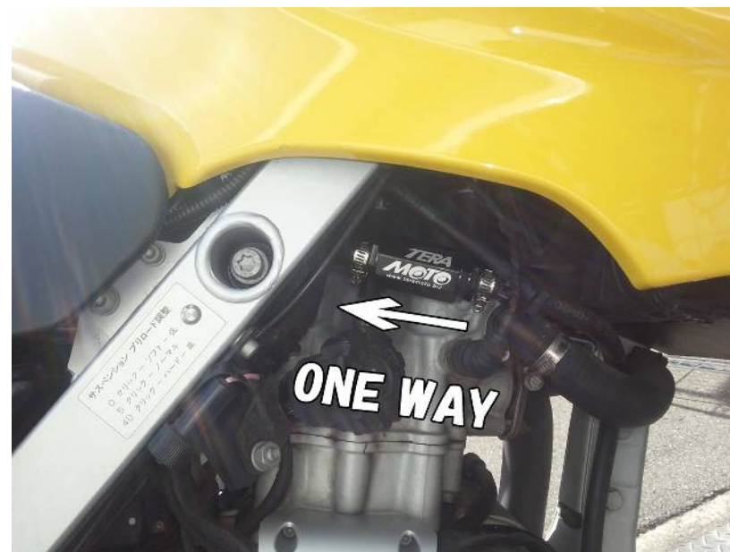
見えているブローバイホースをカットし T-REVを装着するのみです。
