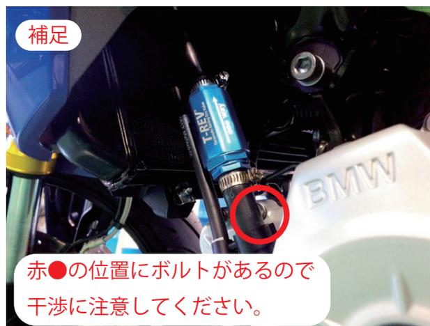
ブローバイホースを 70mm の位置でカットします。T-REV を仮合わせして OUT 側もカットします。付属のホースバンド (13-20) で T-REV IN 側・OUT 側を固定して完成です。
