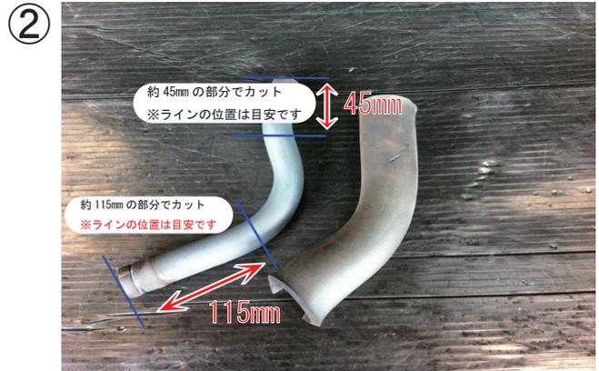
純正ブローバイホースを取り外し、保護スポンジを取り除いてからカットします。
