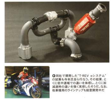
◎オイルキャッチタンクにT-REVを内蔵するタイプも、クラックから直接取り出せなくてもこういう方法で対応することも可能なのだ ◎バンドは通常だとシルバードだが、ユーザーの要望で黒くハードコートしたタイプもラインナップ。キズ付きにくい塗料を用いている ◎オイルフィルターから取り出すためのアダプター。クラックケースから取り出すよりは効果が薄いそうだがT-REV装着を容易にする ◎クラックケースからの取り出しが困難な車種もある。そのためL字型のステーも用意した。また、用途に応じてT字ステーもラインナップ
