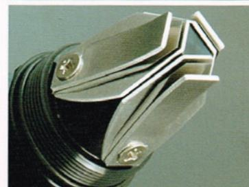
エンジンがかかっている時はピストンが上下している訳だが、その間エンジン内の空気は圧縮を繰り返す。圧縮というのはかなりのパワーを浪費するが、これがボンビングロスと呼ばれるもので、様々な弊害を起こす。そこでプロバイライナーにワンウェイバルブを内蔵したT-REVを割りこませることで、出て行った空気を戻さないようにし、エンジン内部の圧力を下げボンビングロスを軽減。それによりエンジン特性を最適化させるのがT-REVなのだ
