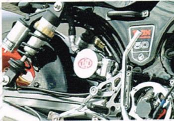
ロンスイ装着に併し、リアフェンダーも後退したことでの隙間を上手く利用した取り付け例。これはぜひ参考にしたい
