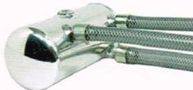
クランクケース内に流れ込んだブローバイガスは、環境面から空気中に排出すると違法となる。そのガスをエアクリに還元するためのフリーザーホースの途中に付け、水分のみを貯めることができるがオイルキャッチタンクなのだ
