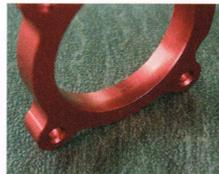
わずか1mm未満となっているためフラットなイメージだが、吸気流速を高めるための絞り込みをスペーサー中央部に与えている。なお、ノーマルではスロットルとインマニの間に少し段付きがあるのだが、スロットル側65.8φ、インマニ側66.8φとしたスロットルスペーサーの装着で段付きは解消できる。
