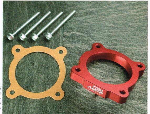
キットにはレッドアルマイト仕上げのスペーサー以外に専用ガスケットと厚みが増す分を考慮したロングボルトをセット。見た目は非常にシンプルだが、長期間にわたってテストを繰り返し仕上げた寺本自動車の自信作だ。現在はノーマルスロットル仕様だが、ビッグスロットル仕様も開発検討中。
