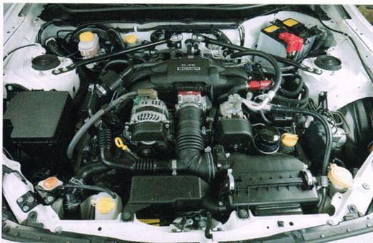
スロットルスペーサーはスロットルボディとインマニの間へ挟み込む形で装着するだけ。吸気抵抗低減や流速アップだけでなく、インマニ容量が増すことでアクセルを踏み返した際のフィルル向上も担ってきた。黒い樹脂パーツが通るエンジンルームのアクセントとなるドレスアップ効果も◎。
