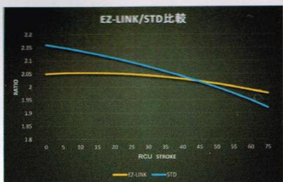
①ノーマルリンクでは右方向にストロークすると、レバー比が急激に落ち込むが、イージーリンクではレバー比の変化が少なく、奥のストローク域でもリヤショックは初期と同じように動いてくれるのだ
