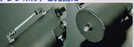
プローバイガスから取り除いたオイルはタンク内へと溜まっていくのだが、本体のゲージを見れば取り外すことなく確認できる。排出する時も本体底部に与えられたドレンボルトを使ってスピーディにメンテができる。
