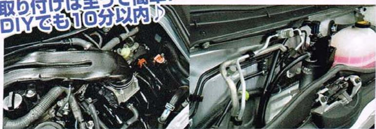
装着スペースの関係からキャッチタンク本体はボンネット内にセットすることとなるが、基本的にはバルクヘッド側からエンジンルームへ差込んだ専用ホースで純正のプローバイラインをTレブ経由とするだけ。Tレブα装着ユーザーのためにタンクのみの販売設定もあるぞ。
