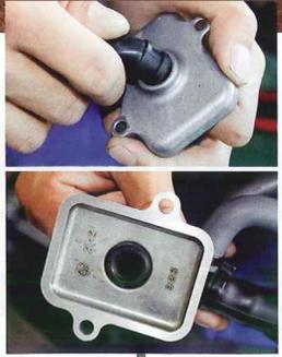
①ノーマルの台座にホースを組み付ける。ホースが硬化しないようにスプレッドに組み付けられる。なお、写真のようにしっかりと組み付けられているかを確認すること
