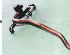
㉒続いてソレノイドバルブを組み付ける。なお、グレーのホースの長さは微妙に違う。長い方を左側(ソレノイドバルブからエアクリナーボックスに伸びるホースの方)、短い方を右側(ソレノイドバルブのカプラー側)になるようにセットすること
