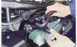
④ソレノイドバルブまわりをエンジン側に取り付け、エンジン左側から差し込むと作業しやすいが、台座がシリンダーヘッドカバーに接触してキズ付かないよう養生テープを使ってガード。クリアランスは狭いが、慎重に戻し、台座部分の固定やソレノイドバルブにカプラーを接続する
