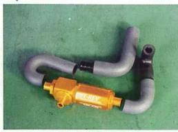
⑦T-REVI ホースを接続する。T-REV内部にはワンウェイバルブが組み込まれ、これによってブロアパイプがエンジンに戻らないようにしているため、向きは写真のとおりになっている。なお、この部分も熱がかかるためホースバンドで固定する
