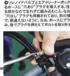
②ソレノイドバルブとエアクリナーボックスを接続するホースに「穴あり」プラグを挿入する。性能を左右する部分なので忘れずに組み込むこと。なお、キットには「穴なし」プラグも同梱されており、別の場所を使うので、間違えないように。なお、ホースにプラグを差し込み、指でプラグを押さえてボルトを取り外すこと
