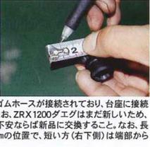
㉓ノーマルのソレノイドバルブには3本のゴムホースが接続されており、台座に接続されているゴムホース2本をカットする。なお、ZR1200ダグエグはまだ新しいため、ホースが劣化している可能性は低いが、不安ならば新品に交換すること。なお、長いホース(左上側)は端部から37mmと74mmの位置で、短い方(右下側)は端部から10mmの位置でカットする
