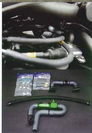
④αシステムは、シリンダーヘッド部の二次エア供給機構に連結され、常時クランクケース内を減圧する(上)。車種ごとに専用設計されているのでボルトオンでの装着が可能で、T-REV本体のカラーは6色から選択できる。なお、ZRX1200ダグ用αシステムは4万9,350円、すでにT-REV採用車T-REVαシステムにグレードアップする場合は3万5,350円、写真のスペシャルキットは5万1,450円だ
