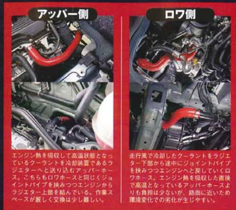
エンジン熱を吸収して高温状態となつてくるクランクケースを冷却装置であるラジエーターへと送り込むアップパーホース、こちらもロフホースと同じくジョイントパイプを挟みつつエンジンからラジエーター上部を結んでいる。作業スペースが狭く交換は少し難しい。
