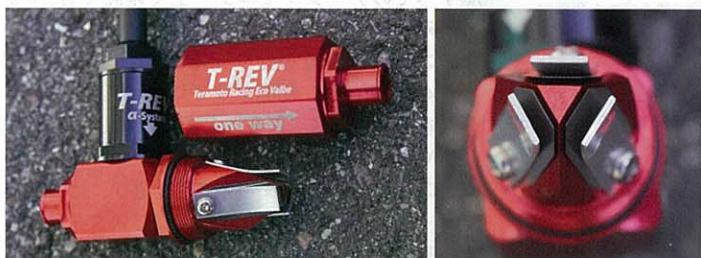
本体内蔵されているワンウェイバルブは、スムーズな排出を促すスパイアル構造+高速稼働得意とするリードバルブで構成されている。バルブはブローバイガスの油分影響で固着しないようにクリアランスが設けられているため、メンテサイクルが長いものもある。なお、外気導入部分はブラックのみだが、本体はレッド以外にブルー、ブラック、シルバー、グリーン、ゴールドのカラーチョイスが可能。エンジルームのドレスアップにも有効だ。
