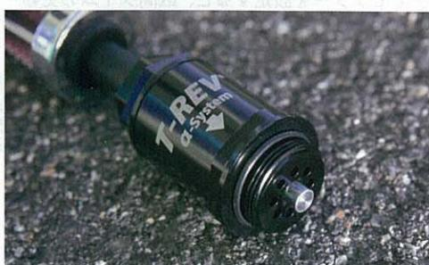
外気導入によって狙いの負圧を実現する秘訣は、アクチュエーター機構にあり。クランクケース内の負圧が高まり過ぎると油圧低下の恐れがあるのだが、αシステムでは内蔵スプリングのセット荷重をコントロールして、設定値以上の負圧になるとバルブが動作して外気が導入されるように仕上げている。
