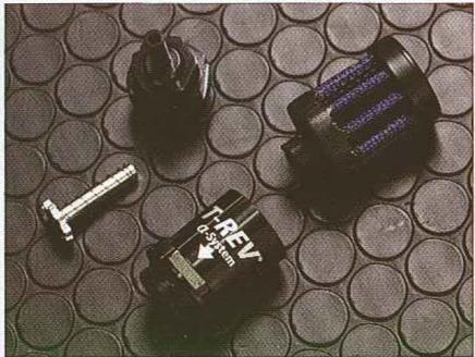
豊富な車種ラインアップのT-REV αシステム。左の画像はキャッチタンク付きの新タイプで86/BRZ用。左上の画像はワンウェイバルブで、右上は負圧調整用バルブ。内蔵されるスプリングのセット荷重をコントロールすることで、狙いの負圧を実現している
