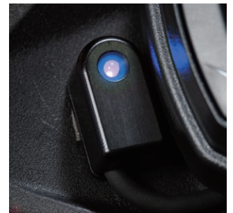
パイロットランプ
