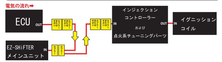
ECU⇒EZ-SHiFTER ハーネス➡インジェクションコントローラー➡イグニッションコイルの順で接続する。 および 点火系チューニングパーツ
